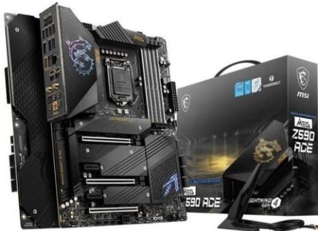
1 . لوحة ATX بالحجم الكامل 305 ملم وعرض 244 ملم، حيث تم تصميم لوحة ATX لتشغيل جميع أنواع الأنظمة. مع ما لا يقل عن 4 وحدات ذاكرة وصول عشوائي DIMM ، و7 فتحات توسيع، مما يتيح لك تشغيل ما يصل إلى 4 وحدات معالجة رسومات مع AMD أو Nvidia أو كما يسمح العدد الكبير من فتحات التوسعة للمستخدمين بتثبيت بطاقة شبكة أفضل يمكنها حتى دعم Wifi ومحولات Bluetooth وبطاقات الصوت ومحاور USB والمزيد .
