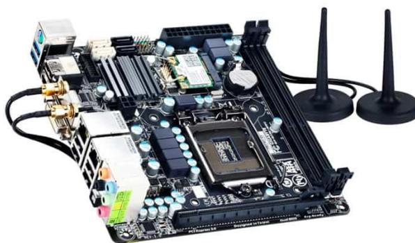
4. لوحة 170x170 Mini-ITX تستخدم غالباً في أجهزة MiniPC لن تجد أكثر من 2 RAM DIMM، مع فتحة توسيعة واحدة. مع عدم وجود دعم لتكوينات GPU المتعددة وعدم وجود طاقة كافية لتشغيل المعالجات المتطورة.
